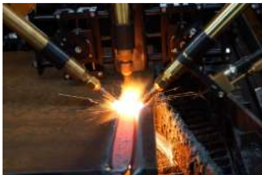
Трехгорелочный суппорт для снятия продольной фаски, с регулируемым установлением и углом
