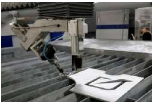
Суппорт Pro-X 3D FL с наклонной головкой - угол регулировки +/- 60°
